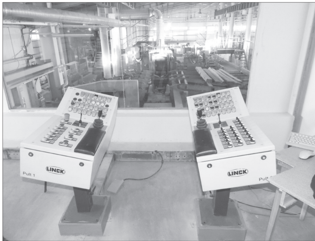
Деревообрабатывающий завод управляется из пультовой. Станок уже давно завезён из Германии и готов к запуску. Заминка вышла только в неправильном монтаже и строительстве здания завода, который возводили, как выясняется, больше по китайским лекалам. Сегодня его приводят в соответствие российским стандартам.
